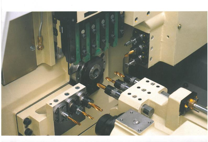
CNC SWISS TYPE AUTOMATIC LATHE
